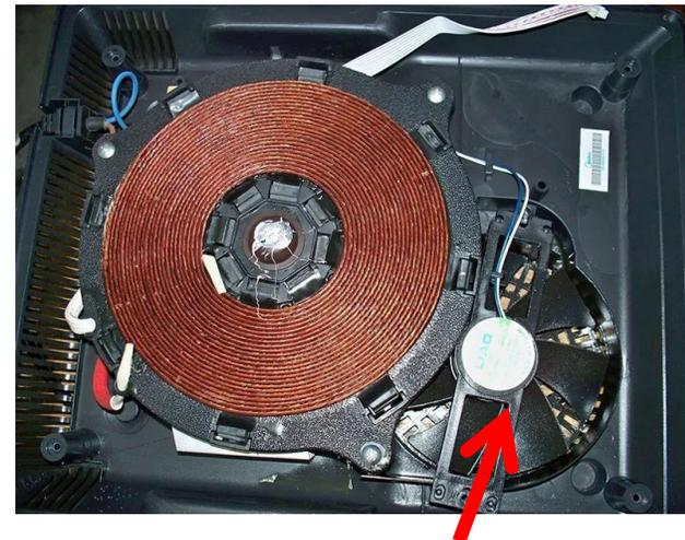
电磁炉散热风扇
